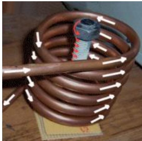
Рисунок 8 - Напрямок струмів в індукторі
